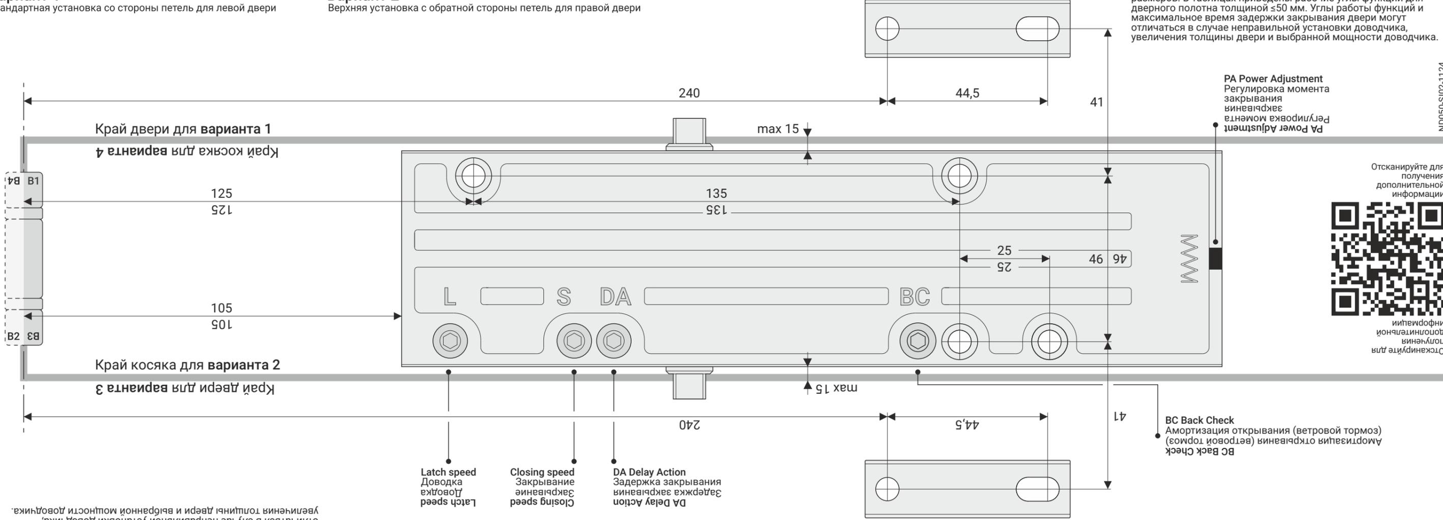
Указанные характеристики верны при установке доводчика строго по монтажной схеме с соблюдением ВСЕХ указанных размеров. В таблицах приведены рабочие углы функций для дверного полотна толщиной ≤50 мм. Углы работы функций и максимальное время задержки закрывания двери могут отличаться в случае неправильной установки доводчика, увеличения толщины двери и выбранной мощности доводчика.
