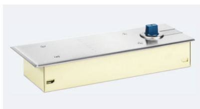
FS-750 PA FS-750 PA+HO Вес двери до 150 кг Усилие EN2-EN4 Ширина двери до 1100 мм Температура -35/+60 °C Габариты цементной коробки 285x82x48,5 мм
