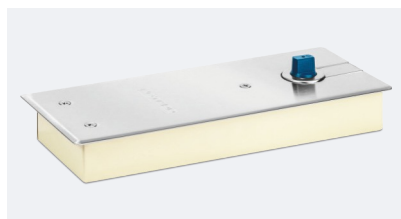
FS-840 FS-840 HO Вес двери до 100 кг Усилие EN3 Ширина двери до 1000 мм Температура -35/+60 °C Габариты цементной коробки 306x108x41 мм
