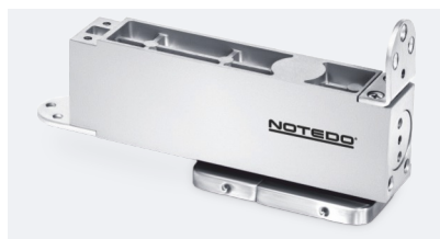
HS-085 HO Маятниковая петля-доводчик Вес двери до 85 кг Усилие EN3 Ширина двери до 1000 мм Температура -35/+60 °C Габариты 183x56x34,5 мм
