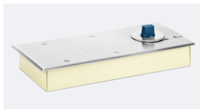
FS-650 FS-650 HO Вес двери до 100 кг Усилие EN3 Ширина двери до 1000 мм Температура -35/+60 °C Габариты цементной коробки 276x108x40 мм
