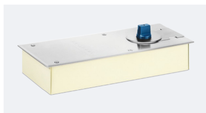
FS-600 FS-600 HO Вес двери до 80 кг Усилие EN2 Ширина двери до 900 мм Температура -35/+60 °C Габариты цементной коробки 258x103x48 мм
